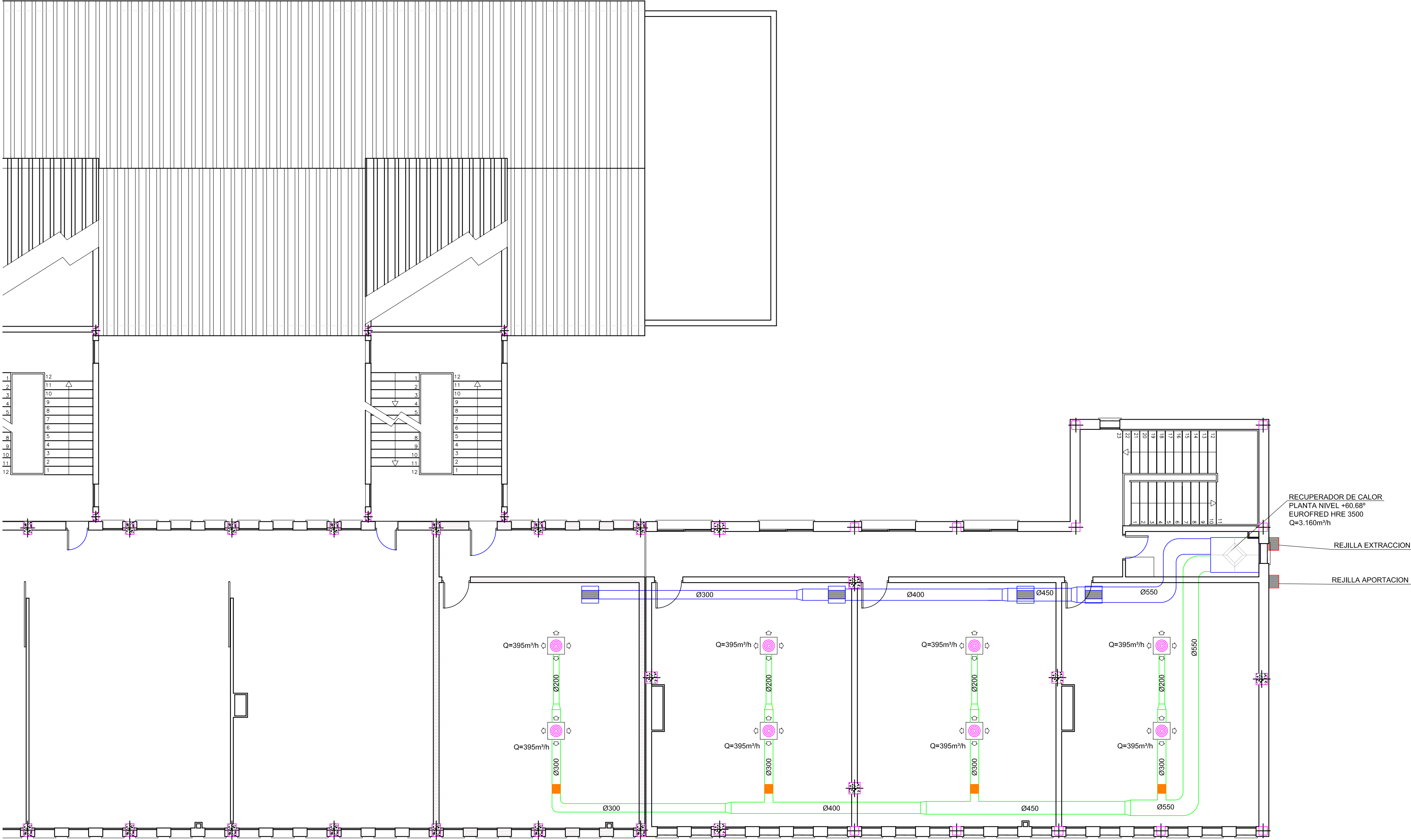
PLANTA NIVEL +60.68° INSTALACION VENTILACION
